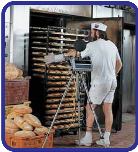
Riceve otto sonde analogiche, una impulsiva, un anemometro a filo caldo e un sensore con uscita 0-4 V. It receives eight analogue probes, one impulse type and one hot wire anemometer.
